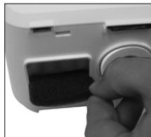
5. Zainstalować osłonę filtra z tyłu urządzenia. **UWAGA** – *W przypadku braku osłony filtra urządzenie nie będzie działać prawidłowo.*
